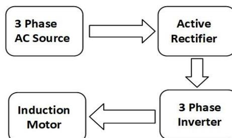
Fig. 3. Block Diagram
